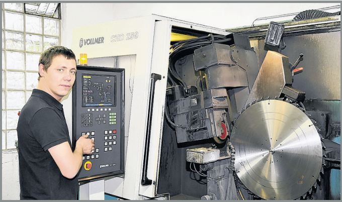
Die qualifizierten Werkzeuge werden durch CNC-gesteuerte Werkzeugschleifmaschinen entwickelt und produziert.
